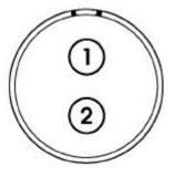
Pin 1 LEFT CHANNEL Pin 2 RIGHT CHANNEL
